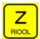
KL02 rioolleiding in watergang of kanaal
